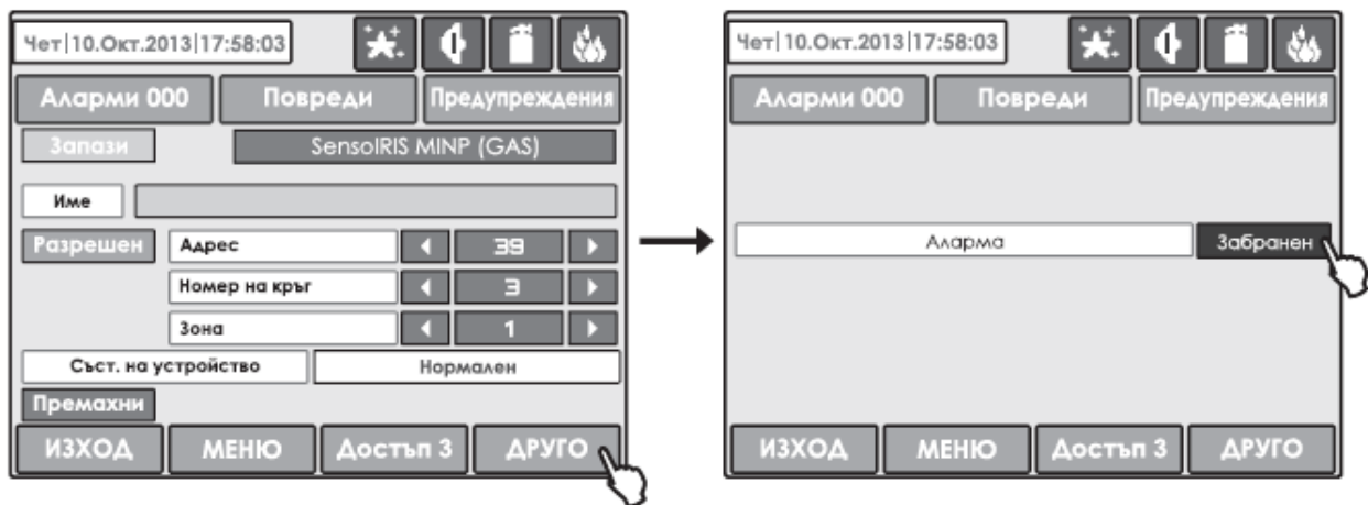
Abbildung Display 10(j) – Abschaltung der Sirenen bei Aktivierung des SensoIRIS MINP (GAS) Moduls.
