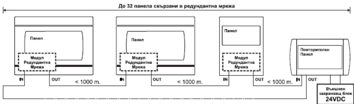
Abbildung 21B. Gesamtstruktur von Zentralen, die in einem redundanten Netzwerk angeschlossen sind (Externer Versorgungsblock 24 VDC; bis 32 Zentralen, angeschlossen in einem Netzwerk)
