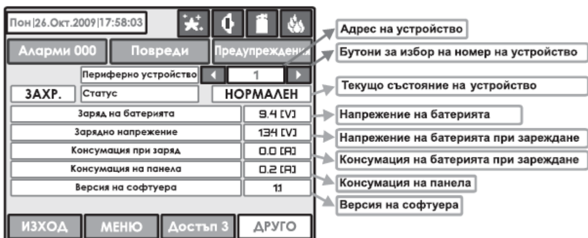
Abbildung Displays 5 – Versorgung (Stromversorgungsblock)
